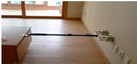
sposób instalacji próbników na powierzchni ściany
