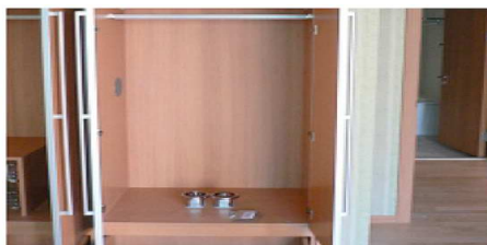
sposób instalacji próbników na powierzchni ściany dennej szafy
