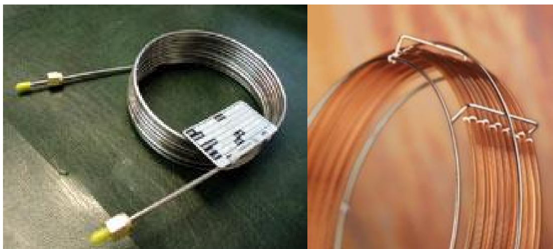
Rys.11 kolumny pakowana (po lewej stronie) i kapilarna (po prawej stronie)
