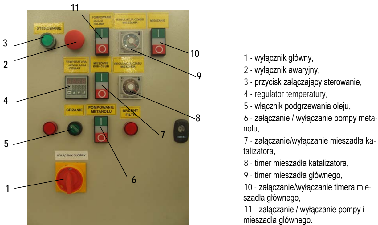
Rys. 2 Pulpit układu sterującego
