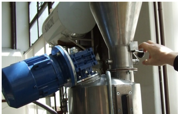
Rys. 6. Dozowanie KOH do zbiornika na mieszaninę katalityczną
