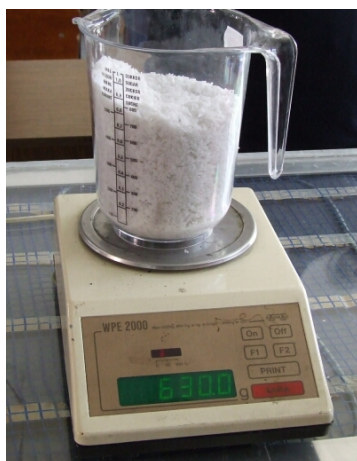
Rys. 4. Odważenie wyznaczonej ilości katalizatora
